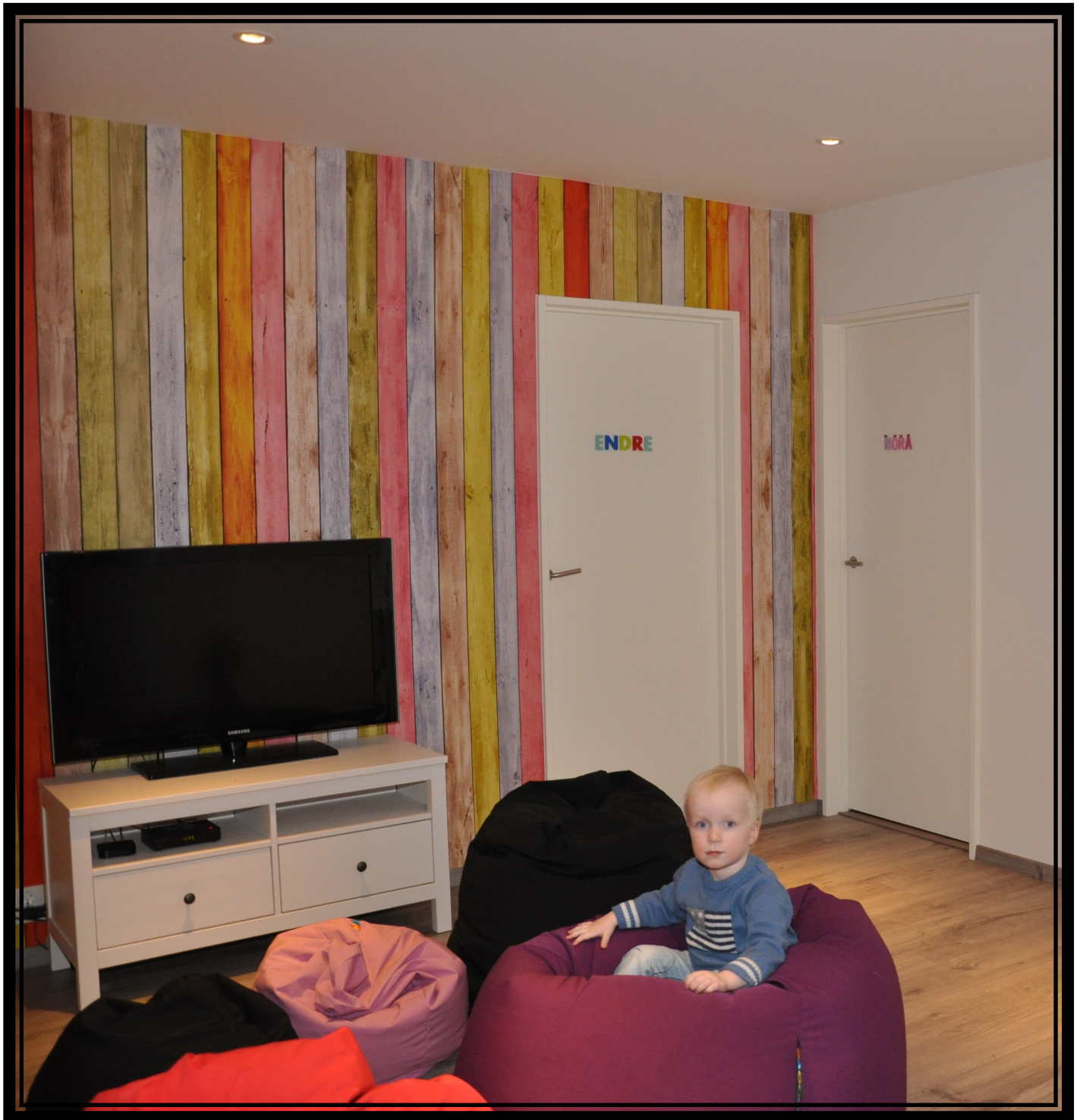
Hvitmalte massive dører. Karmen er av typen funkis fullldybde av fuktbestandig MDF. Vrider Randi 7021.04. Dørene er uten nøkkelhull.
